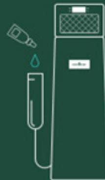
2. Conecte o cilindro de CO<sub>2</sub> e aperte com uma chave inglesa.
